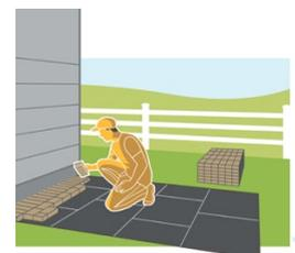
5. Pflaster/Platten auflegen, mit Sand verfugen, verdichten, abwaschen und kehren
