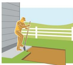
1. Fläche 4-5 cm tief ausheben, verdichten und einebnen
