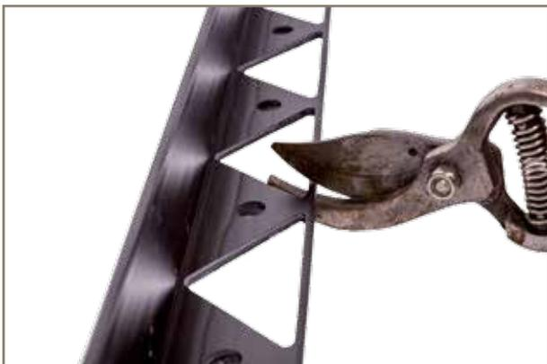
Um ein Biegen der Randleiste in beide Richtungen zu ermöglichen, durchtrennen Sie, wo nötig, die dünnen Stege.
